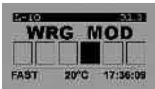
Den felaktiga modulens plats i systemet (här 3:e modulen från höger i en 6-facks kapsling)
