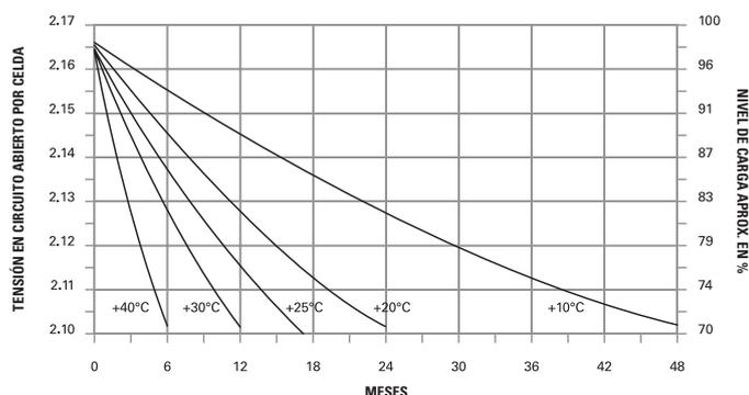
Los tiempos máximos de almacenamiento antes de que necesite una carga de mantenimiento y los intervalos recomendados de comprobación de la tensión en circuito abierto son:
