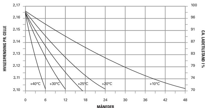
De maks. lagertider, der er mulige, før det bliver nødvendigt at gennemføre en vedligeholdelsesopladning, og de anbefalede intervaller, der skal overholdes for at kontrollere hvilespændingen, er følgende:
