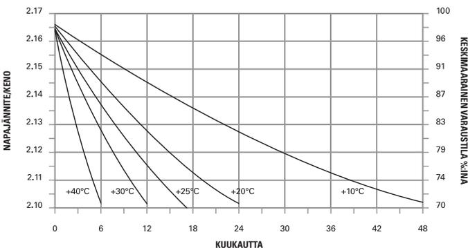
Pisimmät sallitut säilytysajat ennen kuin virkistysvaraus on suoritettava sekä suositellut napajännitteen tarkastusväli ovat seuraavat:
