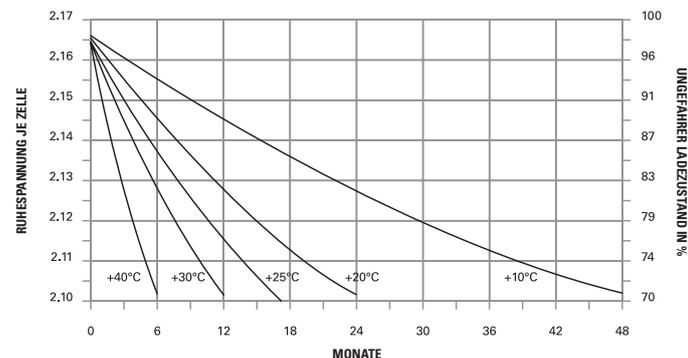
Die maximal zulässigen Lagerzeiten bis zu einer notwendigen Nachladung sowie die empfohlenen Prüfintervalle der Ruhespannung OCV sind wie folgt:
