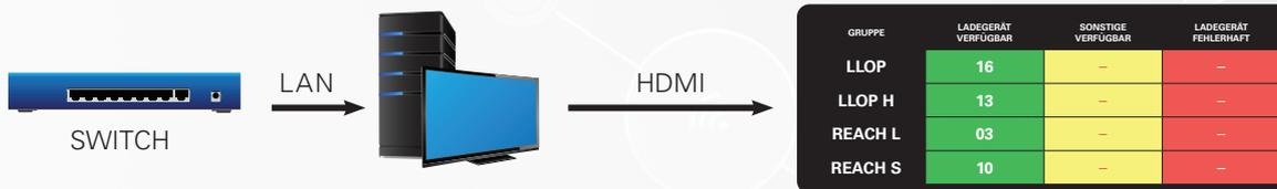
In der Ladestation wird vor Ort ein Netzwerkschrank aufgestellt. Ein PC und ein Switch sind erforderlich, um alle Ladegeräte mit dem PC zu verbinden und das System in Betrieb zu nehmen. Der FiFo-Bildschirm (First in, First out) wird als zusätzlicher Monitor direkt an den PC angeschlossen. Dieser PC kann optional mit dem Internet verbunden werden, sodass ein Fernabruf möglich ist.
