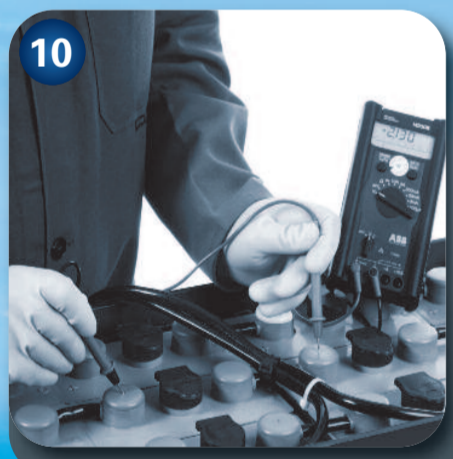
10 Mesurer la tension aux bornes de chaque élément.
