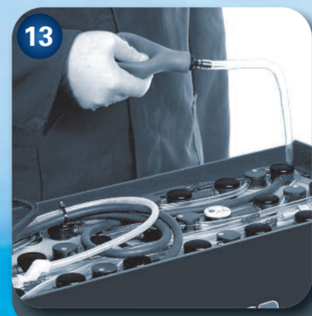
13 Nettoyer la batterie si des valeurs de résistance sont trop élevées. Vidanger l'intérieur du coffre.
