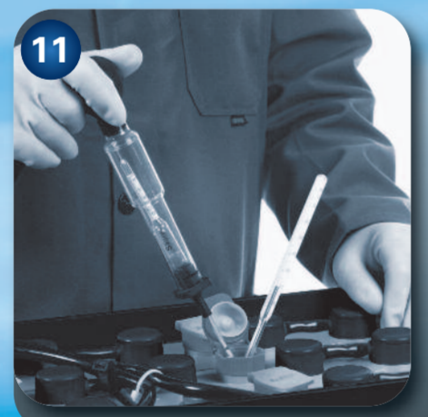
11 Mesurer la température et la densité de l'électrolyte.
