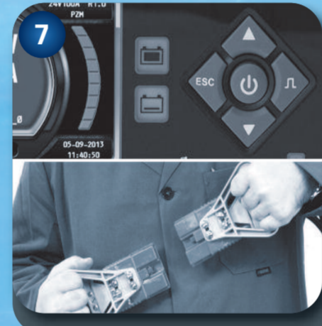
7 Couper le chargeur via le bouton Marche/Arrêt ou vérifier qu'il soit débranché. Déconnecter le chargeur. Le cas échéant, déconnecter le système de brassage d'électrolyte. Relever éventuellement les valeurs affichées (pour un suivi de parc).
