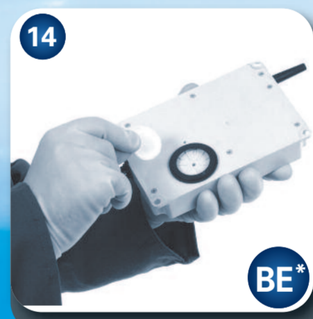
14 Remplacer le filtre aeromatic ; vérifier le fonctionnement de la pompe à air.
