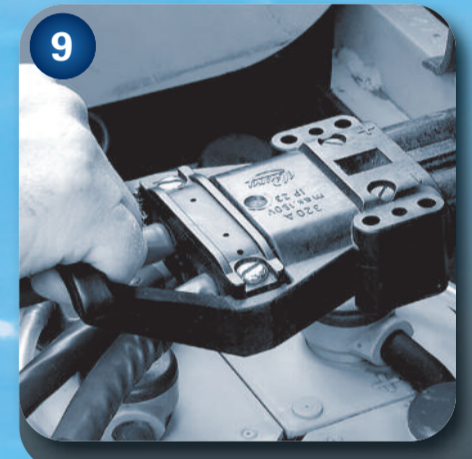
9 Contrôler visuellement tous les composants de la batterie (particulièrement les prises et câbles) afin d'exclure toute dégradation mécanique.
