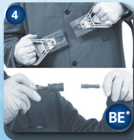
4 Brancher la prise du chargeur. Connecter éventuellement le système de brassage d'électrolyte (BE) (pour des prises sans entrée d'air).
