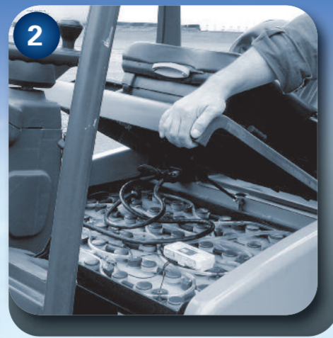
2 Soulever le couvercle de la batterie; les bouchons des éléments de la batterie restent fermés.
