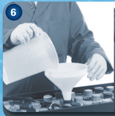
6 Remise en eau. Remplir d'eau déminéralisée si besoin. Se référer au point 3 (tableau relatif aux indicateurs de niveau). La remise en eau doit être effectuée 20 minutes avant la fin de la recharge ou immédiatement après la recharge.
