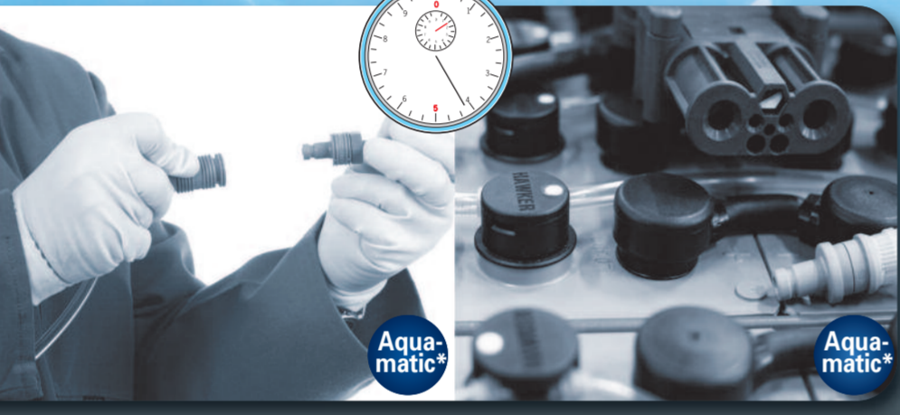
6 Remise en eau. Remplir d'eau déminéralisée si besoin. Se référer au point 3 (tableau relatif aux indicateurs de niveau). La remise en eau doit être effectuée 20 minutes avant la fin de la recharge ou immédiatement après la recharge.
