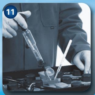
**11 Misurare la densità e la temperatura dell'elettrolito.**
