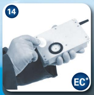
**14 Sostituire il filtro della pompa.**
