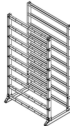
INSTALL FRONT HORIZONTAL CHANNELS
