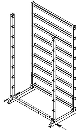
INSTALL FRONT HORIZONTAL CHANNELS
