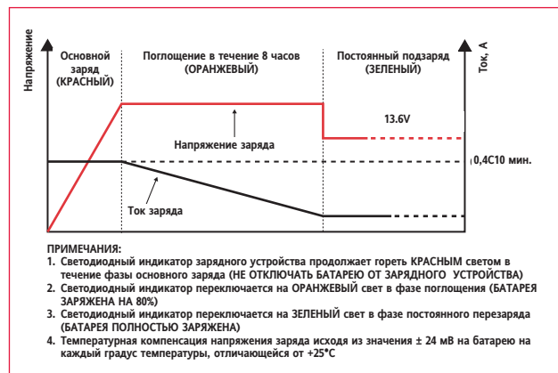
Рисунок 2.8.1: Трехэтапный метод заряда (IUU)
