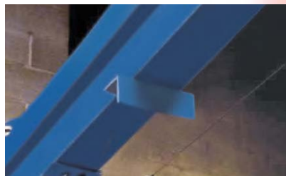
Butée de palan réglable (Aide au positionnement précis de la batterie et prévient tout dommage)
