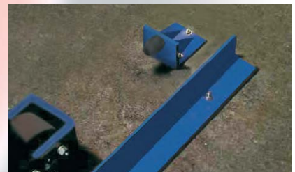
Rail de guidage du portique
