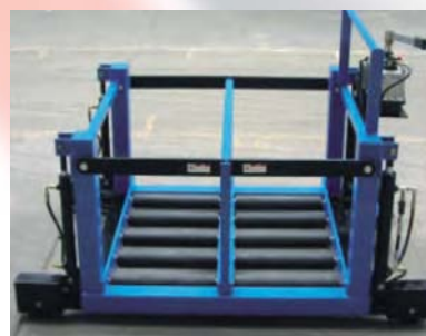
Hauteur de roulement réglable – 115 – 419 mm
