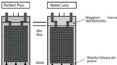
Controllare il livello dell'elettrolito ed eventualmente rabboccare se necessario (rispettare il massimo livello in accordo con il disegno)
