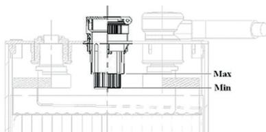
Se viene aggiunta acqua in misura eccessiva, l'espansione dell'elettrolito in fase di ricarica ne determina il traboccamento e di conseguenza l'indebolimento. Se, viceversa, la quantità di acqua aggiunta è insufficiente, le sommità delle piastre rimangono esposte, il che pregiudica le prestazioni e la durata della batteria.
