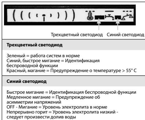
Wi-iQ - это электронное устройство, которое способно загружать ключевую информацию о батарее с целью улучшения диагностики и обслуживания. Устройство подключается к магистральному кабелю постоянного тока батареи для контроля и регистрации данных о токе, напряжении, температуре и уровне электролита (через наружный дополнительный датчик). Светодиоды на приборе Wi-iQ обеспечивают пок зания состояния батареи в реальном времени. Информация передается на ПК через модем USB по беспроводному каналу.
