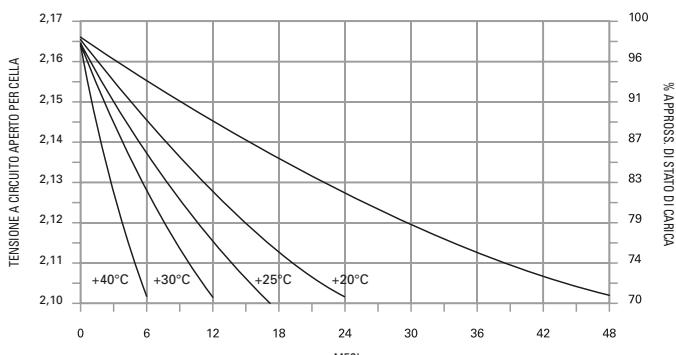
I tempi di immagazzinamento massimi prima che sia necessaria una carica di rinfresco e gli intervalli di controllo della tensione a circuito aperto raccomandati sono i seguenti:
