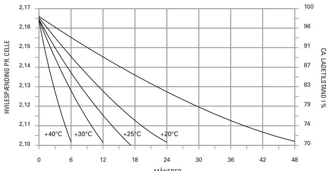
De maks. lagertider, der er mulige, før det bliver nødvendigt at gennemføre en vedligeholdsesoplædning, og de anbefalede intervaller, der skal overholdes for at kontrollere hvilespændingen, er følgende:
