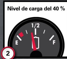
**2** Para maximizar la vida útil de la batería, el nivel de carga no debe ser inferior al 40 %.
