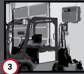
**3** Las cargas parciales maximizan la vida útil de la batería NexSys<sup>®</sup> TPPL. Enchufe durante todo el tiempo de inactividad (cuando el vehículo no esté en uso).
