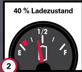
**2** Für eine maximale Lebensdauer der Batterie sollte der Ladezustand der Batterie nie unter 40 % sinken.
