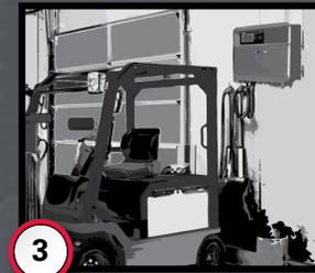
**3** Zwischenladungen erhöhen die Lebensdauer der NexSys<sup>®</sup>-TPPL-Batterie. Schließen Sie die Batterie während aller Stillstandszeiten an (wenn das Fahrzeug nicht in Gebrauch ist).
