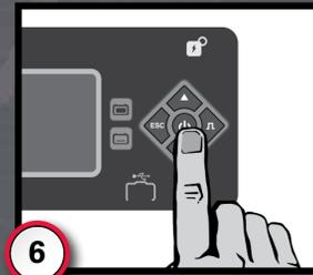
**6** Appuyez sur le bouton STOP avant de débrancher la batterie du chargeur.
