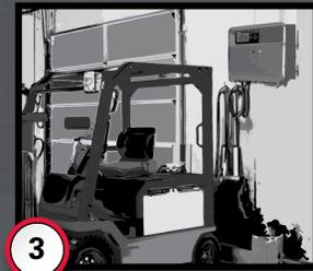
**3** La charge partielle maximise la durée de vie de la batterie NexSys® TPPL. Branchez-la pendant toute la durée de l'immobilisation (lorsque l'engin n'est pas utilisé).
