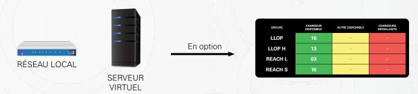
Aucune installation sur site n'est nécessaire. Les chargeurs seront connectés via Ethernet au réseau du client. Le programme sera installé sur le serveur fourni par le client (même réseau que les chargeurs). C'est une solution parfaite pour que la direction puisse accéder aux données en temps réel depuis n'importe où, que ce soit un bureau sur le même site ou à distance. FiFo (First in, First out) facultatif pour cette option.
