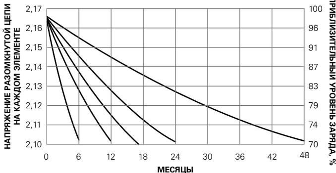
Максимальное время хранения до требуемого восстанавливающего заряда и рекомендуемые интервалы проверки напряжения разомкнутой цепи:
