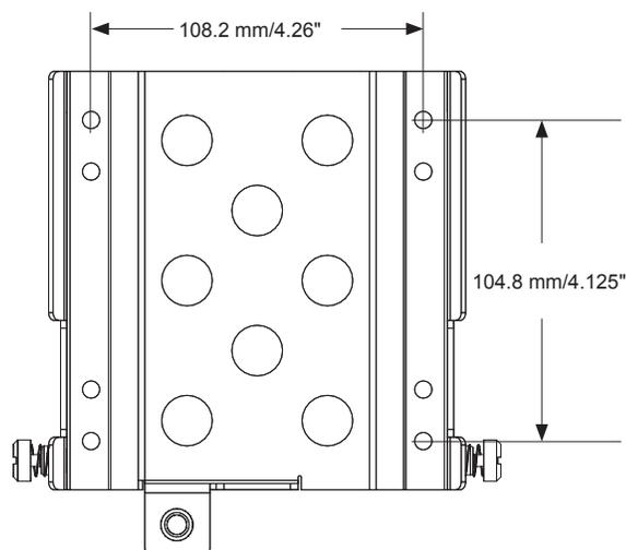
Fig. 1, Medidas de los orificios de montaje
