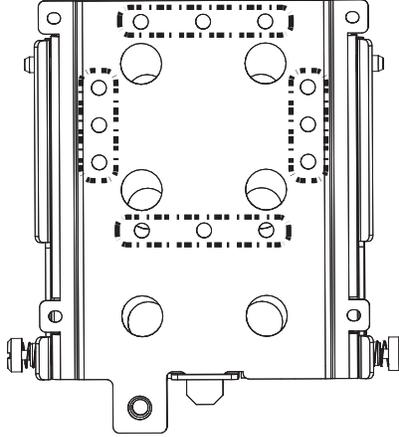
**Fig. 3, Orificios de montaje para dispositivos Wi-Fi**
