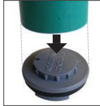
2. Ajuster la pompe de remplissage manuel sur la tourie d'acide. Vérifier que la pompe est vissée fermement sur la tourie. La densité de l'acide sulfurique de remplissage (à 20°C) est de 1,280.
