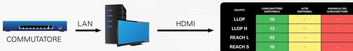
Un armadio di rete è posizionato in loco nella sala di ricarica. Per collegare tutti i caricabatterie al PC e far funzionare il sistema sono necessari un PC e un commutatore. Lo schermo FiFo (prima a entrare-prima a uscire) viene collegato direttamente al PC come monitor aggiuntivo. Questo PC può essere collegato opzionalmente a Internet, consentendo così l'accesso da remoto.
