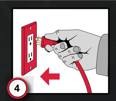
Branchez le cordon d'alimentation secteur. Les contacteurs de déconnexion de l'alimentation de l'engin se déclenchent automatiquement pendant la charge.
