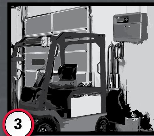
3 Privremeno punjenje maksimalno povećava radni vek NexSys<sup>®</sup> TPPL akumulatora. Držite priključeno tokom vremena zastoja (kada se vozilo ne koristi).
