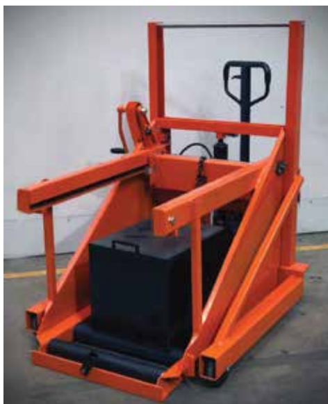
Pohodlné zvedání a spouštění do výšky pasu pomocí ručního ovládání
