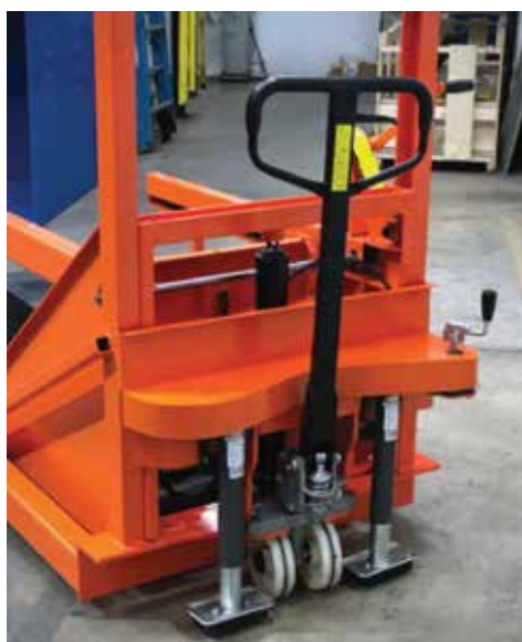
Volitelný ruční pozitivní brzdový systém ovládaný klikou bez zpětného rázu při aktivaci brzdy
