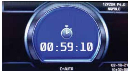
5.4.2. **Sans appareil Wi-iQ<sup>®</sup>** : Si l'adaptateur d'appareil Wi-iQ n'est pas activé ou si aucun appareil Wi-iQ n'est à portée, la charge effective commencera après la période programmée. **Le chargeur utilise les paramètres de profil, de capacité et de température programmés dans le menu de configuration.**
